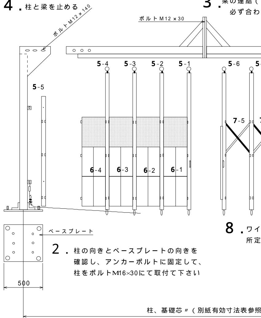
3. 梁の連結 (レールのレベルを必ず合わして下さい)
