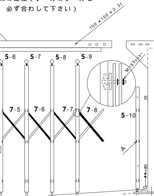
2. 柱の向きとベースプレートの向きを確認し、アンカーボルトに固定して、柱をボルトM16×30にて取付て下さい
