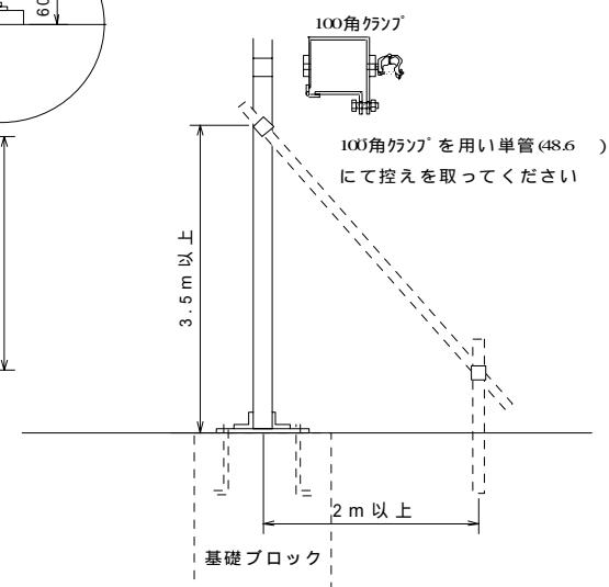
**注意!** 基礎ブロックにてゲート設置時は、必ずサイズに関係なく単管もしくは、それに匹敵するもので控えをとってください。なお、台風や風速20m以上の強風が出る恐れのある場合は必ず開口してください
